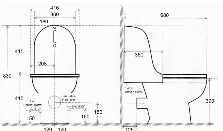
\* Branchement de l'alimentation 12 Volts sur prise 230 V dissimulé derrière l'appareil. Si possible, utiliser un emplacement protégé des projections d'eau et du vol (local technique ou pièce attenante, faux plafond...).
