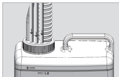
NOTE : le kit d'alimentation multiple permet de relier jusqu'à 6 distributeurs de savon simultanément. En cas d'installation avec moins de 6 distributeurs, veiller à obstruer les trous restants avec les bouchons fournis.
