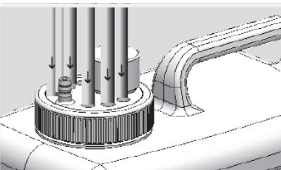
**NOTE :** le kit d'alimentation multiple permet de relier jusqu'à 6 distributeurs de savon simultanément. En cas d'installation avec moins de 6 distributeurs, veiller à obstruer les trous restants avec les bouchons fournis.
