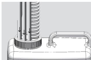
NOTE : le kit d'alimentation multiple permet de relier jusqu'à 6 distributeurs de savon simultanément. En cas d'installation avec moins de 6 distributeurs, veiller à obstruer les trous restants avec les bouchons fournis.
