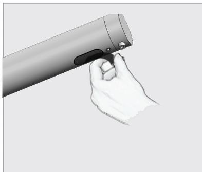
Brancher le connecteur moteur au connecteur alimentation électrique.
