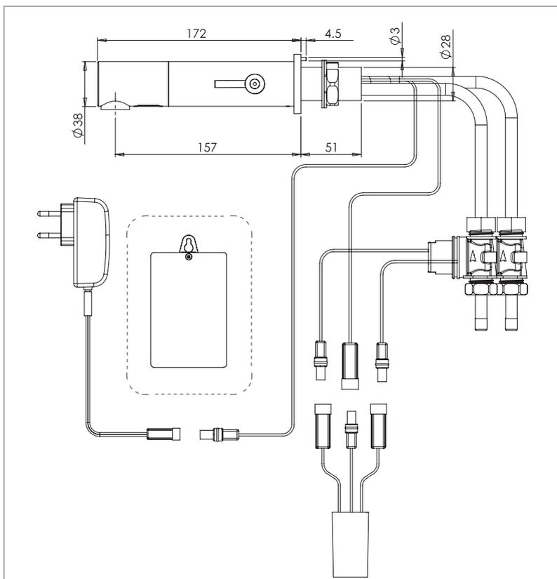
**Alimentation :** transformateur 230 / 9 V ou boîtier pile (6x1.5V ou 1x9 V).
