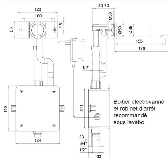
Boîtier électrovanne et robinet d'arrêt recommandé sous lavabo.
