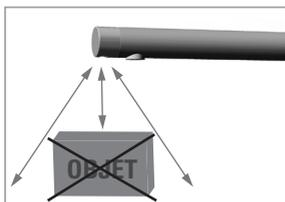
Avant l'étape 3, vérifier qu'aucun objet n'est dans l'aire de détection sur le lavabo.
