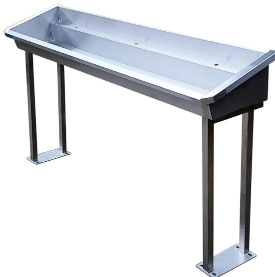
Lavabo rigole collectif fabriqué en acier inoxydable qualité AISI 441, finition satiné, épaisseur côtés 1,5 mm / cuve 0.8 mm. Hauteur fixe lavabo 850 mm.
