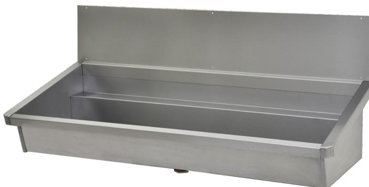
Lavabo rigole collectif avec dossieret, fabriqué en acier inoxydable qualité AISI 441, finition satiné. Epaisseur côtés 1,5 mm / cuve 0.8 mm.
