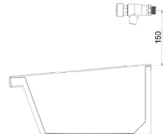
Profondeur de cuve 142 mm. Grille centrale perforée de vidage 1 1/2".
