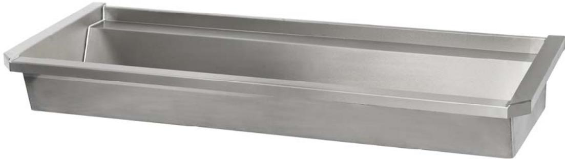
Lavabo rigole collectif fabriqué en acier inoxydable qualité AISI 304, finition satiné, épaisseur côtés 1,5 mm / cuve 1 mm.
